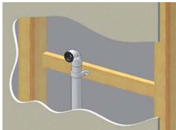
Obr. 15: Příprava připojení odvodu kondenzátu na svislý odpad
