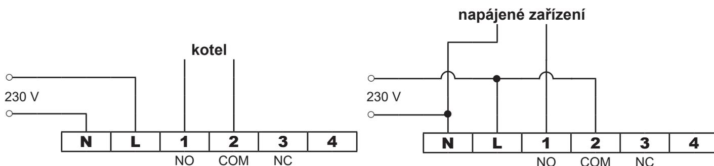
Napětí na svorkách 1 a 2 závisí výhradně na řízeném systému, proto i průřez kabelů se musí řídit typem zařízení, které bude termostat ovládat. Délka kabelů nehraje žádnou roli, přijímač se může umístit poblíž kotle nebo daleko od něj, ale nikdy pod jeho plášť.
