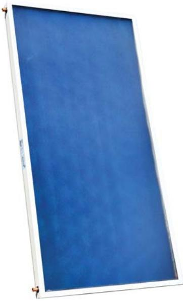
Plochý kolektor s výkonom 1481 W (při osvitu 1000 W/m<sup>2</sup>) určený k vertikální montáži nad střešní krytinu. Lyrový absorbér s vysoko selektivním povrchem TiNOx je spojen s měděným potrubím technologií laserového svařování. Izolaci tvoří 40mm vrstva minerální vlny. Připojení je umístěno nahoře a dole po stranách.
